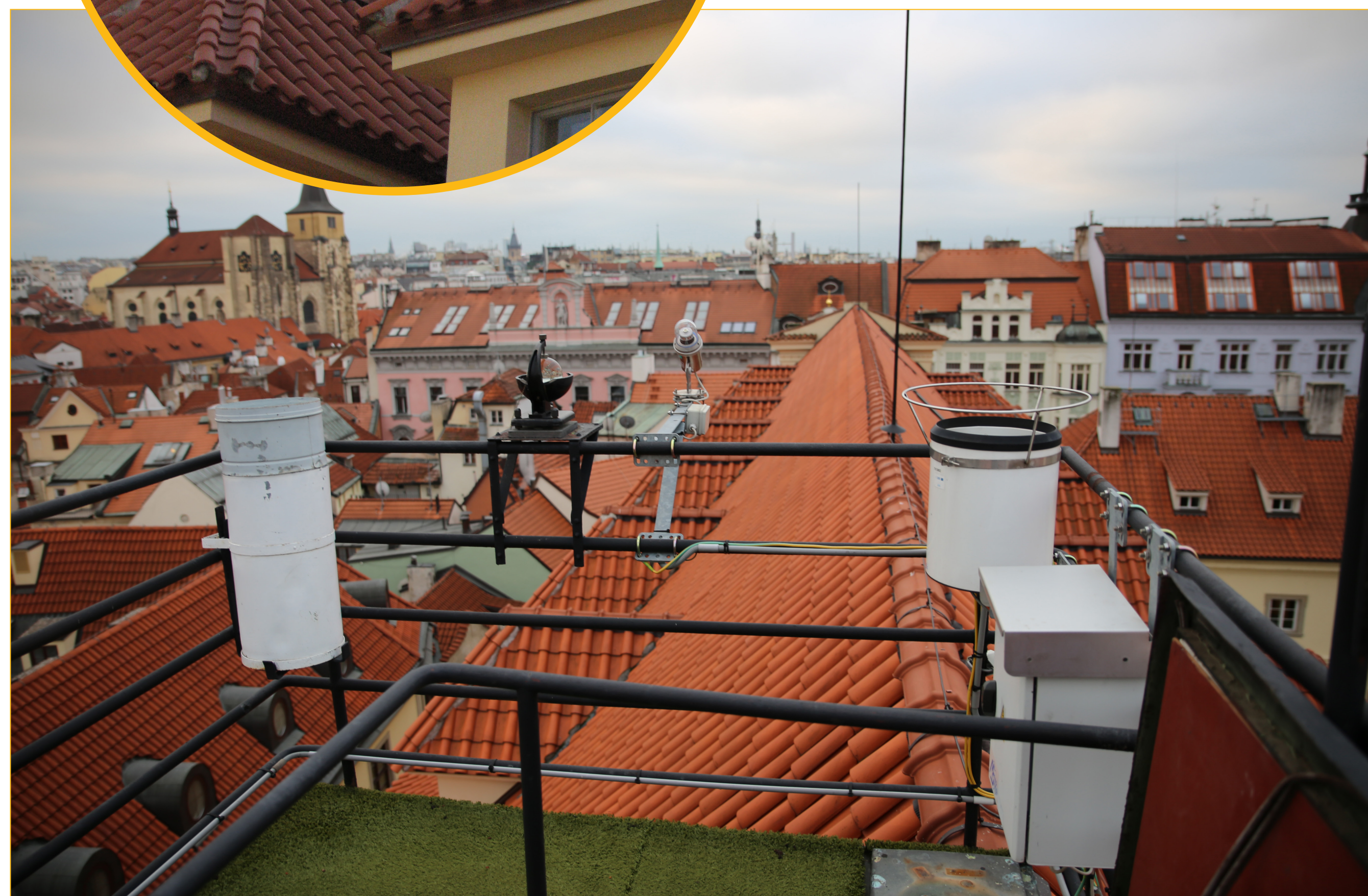
Meteorologická střešní zahrádka s měřením srážek, trvání slunečního svitu a rychlosti a směru větru.
