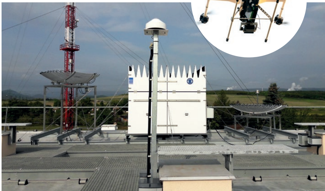
Pohled ze střechy observatoře Tušimice, tj. radioakustický systém SODAR-RASS pro měření profilů teploty a větru (střed obrázku), 80 m meteorologický stožár pro měření profilů teploty, vlhkosti a větru (v pozadí vlevo), vlečky z elektráren Prunéřov (v pozadí vpravo). Foto: Archiv ČHMÚ.
