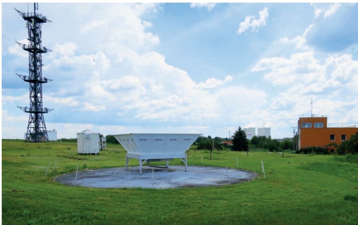
Observatoř Temelín s windprofilerm Scintec LAP®3000. Foto: Archiv ČHMÚ.
