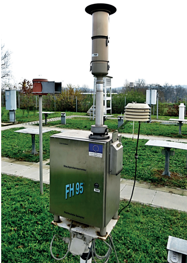
Obr. 21 Jeden z typů vzorkovačů pro denní odběr suspendovaných částic na filtr, Ostrava-Poruba/ČHMÚ 2014 (B. Krejčí).
