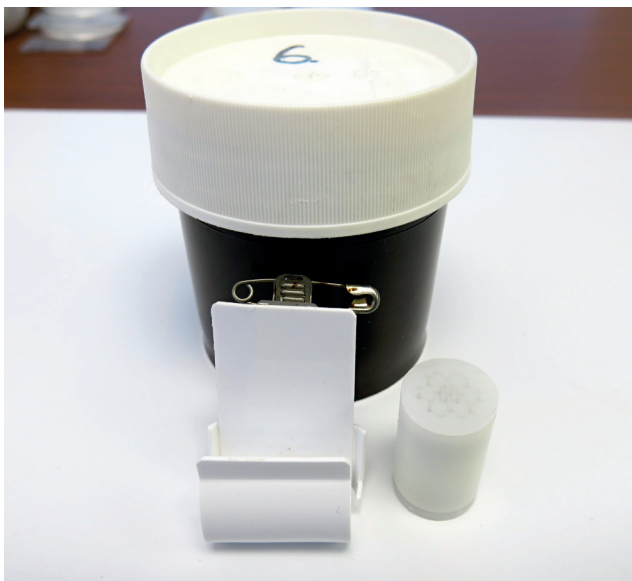
Obr. 72 Vybavení pro odběr vzorků a stanovení koncentrací ozonu pasivním dozimetrem (L. Böhmová).
