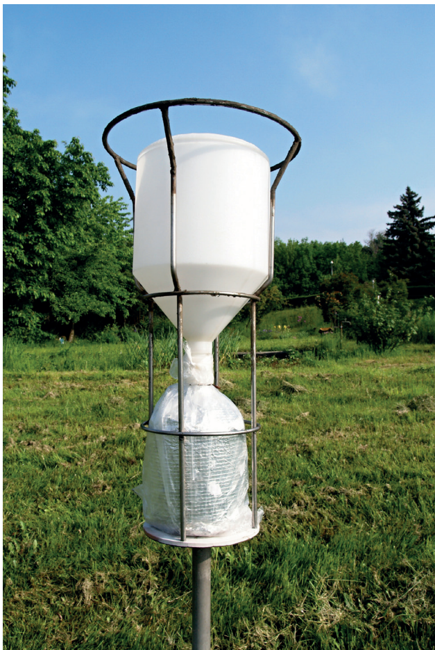
Obr. 24 BULK – odběrové zařízení srážkoměrné sítě v Ostravě-Porubě/ČHMÚ v roce 2008 (B. Krejčí).
