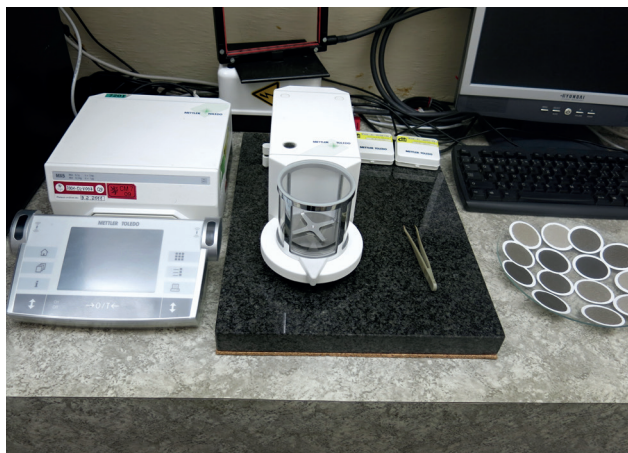
Obr. 19 Vážení filtrů pro stanovení koncentrací suspendovaných částic gravimetrickou metodou na analytických vahách Mettler s citlivostí až jedné miliontiny gramu v roce 2013 (L. Böhmová).
