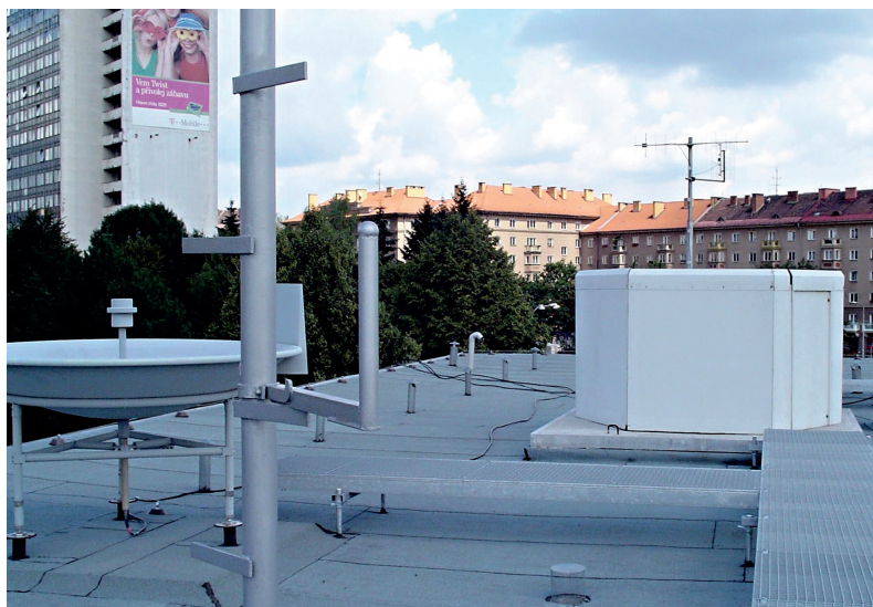
Obr. 35 Vysílací a přijímací antény systému SODAR-RASS na střeše pobočky v Ostravě, 2003 (V. Seberová).
