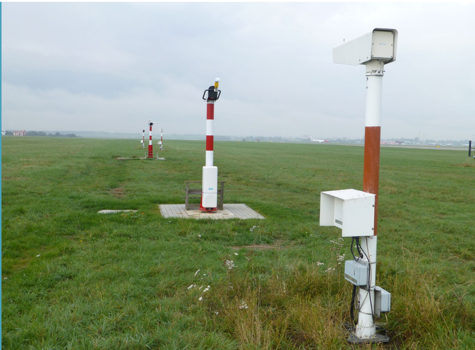
Starý typ transmisometru MITRAS double base byl vyměněn za nový LT31 na letišti Praha-Ruzyně. Foto: Petr Černý.
