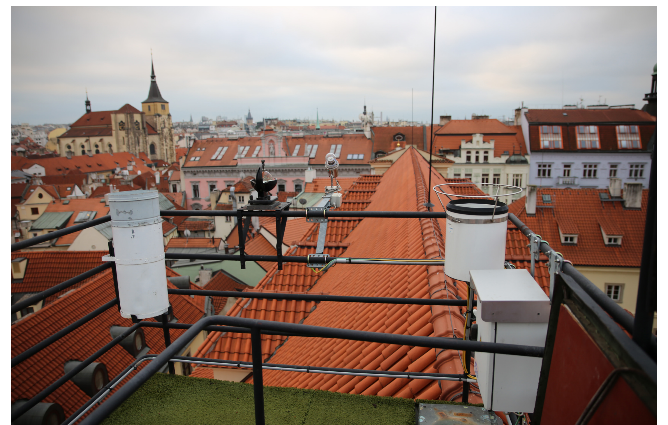
Meteorologická střešní zahrádka s měřením srážek, trvání slunečního svitu a rychlosti a směru větru.
