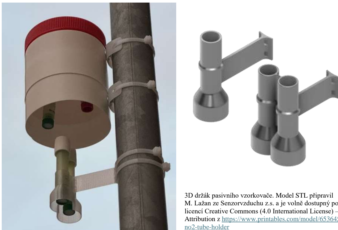
Obrázek 1 Uchycení pasivních vzorkovačů na stanici Legerova. Vlevo: bílá krabička s červeným víčkem je doporučený držák od spol. Passam ag, pod ní pak držák používaný v této kampani na všech ostatních lokalitách (buď ve variantě pro jednu, nebo dvě trubičky - viz též obrázek vpravo). Zelené víčko na spodní části trubiček je ochranný filtr, který má zajistit stejnou rychlost difuze za různých rychlostí větru a také ochranu proti prachu a hmyzu.
