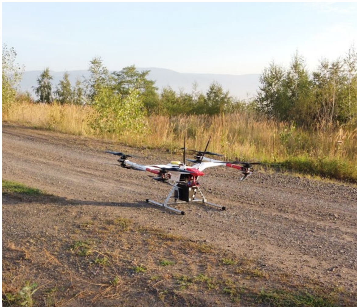
Obr. 12 Dron sloužící jako nosič přístrojů pro měření kvality ovzduší (foto: Observatoř Tušimice)
