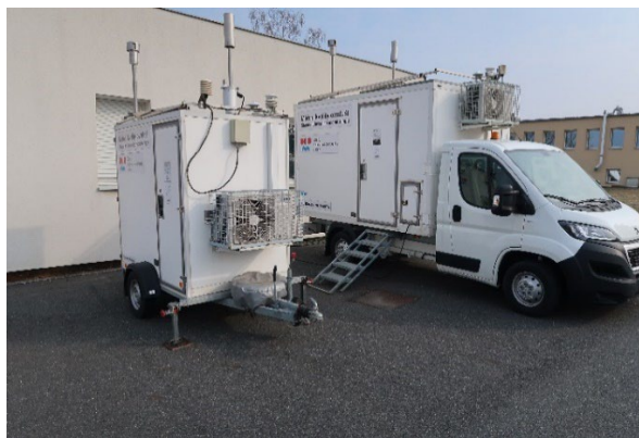
Obr. 9 Měřicí vůz s vybavením pro měření kvality ovzduší v SSIM (foto: CLI Praha Libuš)
