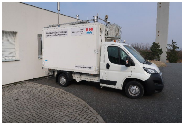
Obr. 9 Měřicí vůz s vybavením pro měření kvality ovzduší v SSIM (foto: CLI Praha Libuš)
