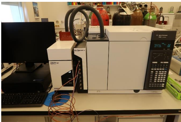
Obr. 13 Analyzátor GCMS pro stanovení těkavých organických látek (VOC) odebíraných do kanystrů (foto: CLI Praha Libuš)
