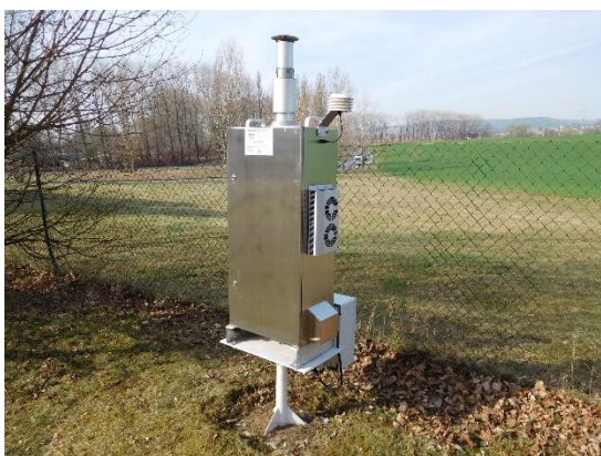
Obr. 7 Stanice MIM Vyškov – vzorkovač (foto: P-ČHMÚ Brno)
