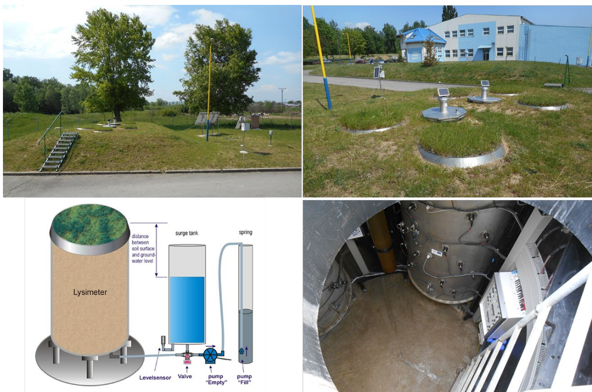
Obr. 1 Lyzimetrická stanica v Petrovciach nad Laborcom (Branislav Kandra, vlastný zdroj).
