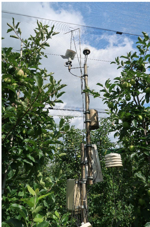
Obr. 2 Automatické meteostanice s dálkovým přenosem dat pro sledování meteorologických podmínek v ovocném sadu v reálném čase. VŠÚO Holovousy.
