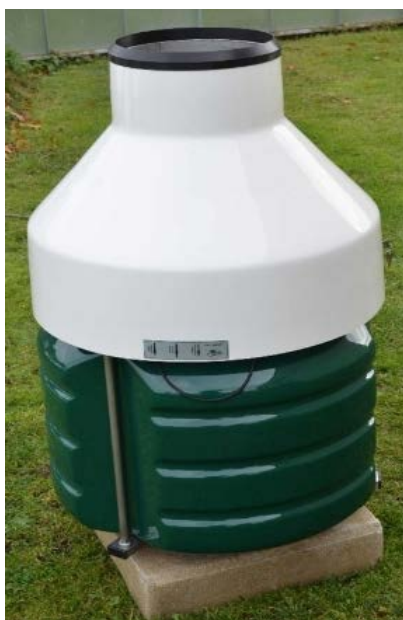
Obr. 3 Váhový srážkoměr (typ MRW500)
