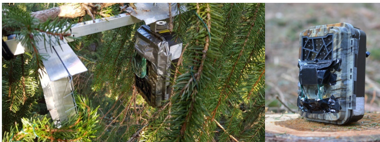
Obr. 1 Detail upravené fotopastí (vpravo) a detail uchycení na rámu (vlevo).
