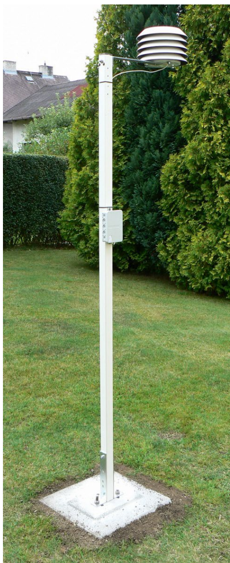
Obr. 3 Ukázka instalace/umístění teplotního čidla
