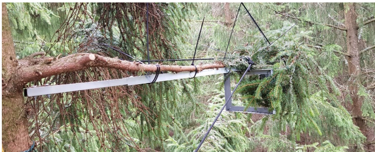
Obr. 2 Detail připevnění rámu s fotopastí k větvi.
