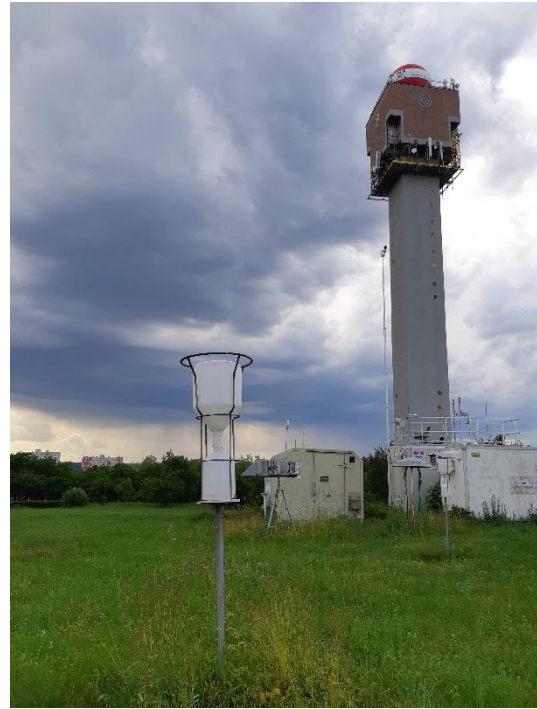
Fig. 18 “Bulk” sampler, Prague-Libuš station (Photo: E. Svobodová)
