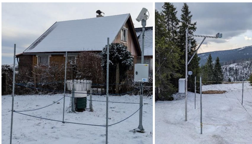
Fig. 3 and 4 Automatic snow station – laser type (SHM31, left) and ultrasonic type (right). Obr. 3 a 4 Automatická sněhoměrná stanice – laserová (vlevo) a ultrazvuková (vpravo).
