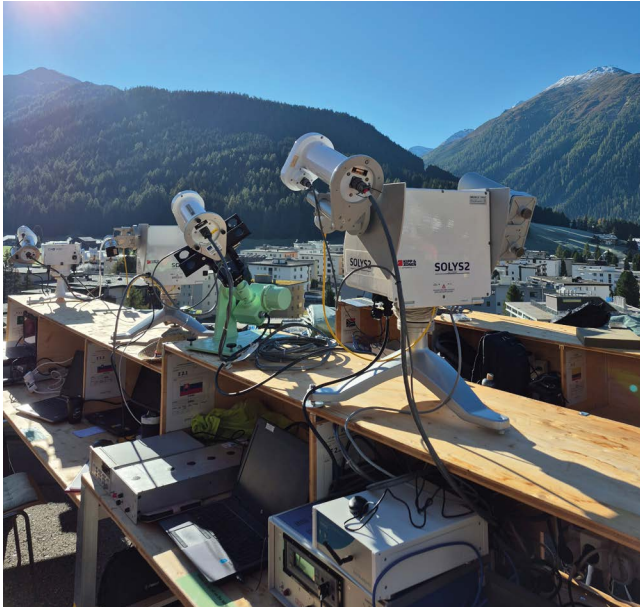
Kalibrační stanoviště pyrliometrů během mezinárodního porovnání IPC-XIV ve Světovém radiačním centru (WRC) v Davosu, Švýcarsko. Foto: M. Stráník.
