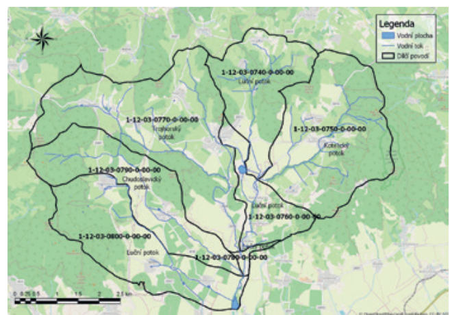
Obr. 2 Využívání území v povodí pro stanovení např. pokrytí povodí lesním porostem (vlevo) a rozdělení povodí na jednotlivá dílčí povodí (vpravo).
