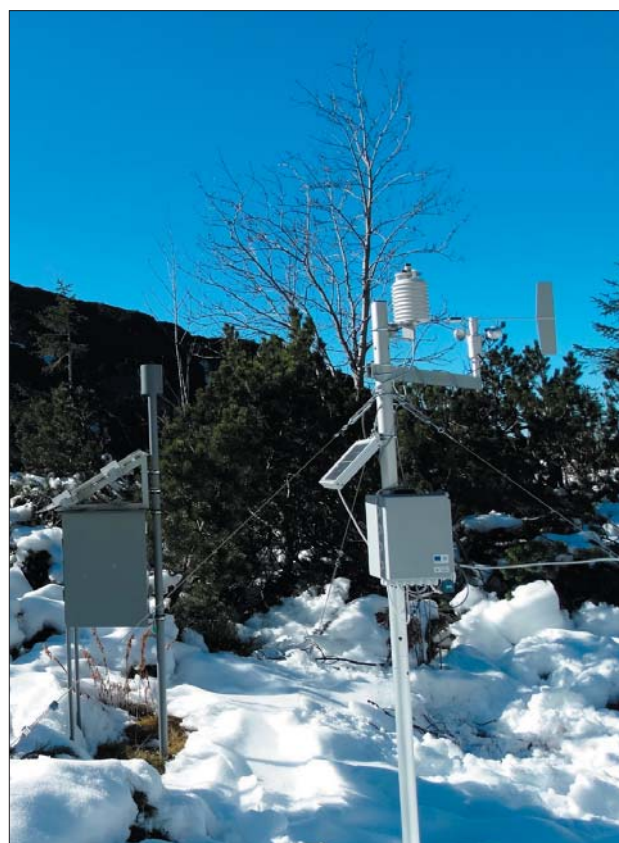
Obr. 2 Ukážka prístrojového vybavenia na výskumnej ploche Kolové pleso (v popredí meteostanica EMS Brno, v pozadí prenosný ozónový analyzátor 2B Tech napájaný solárnym panelom).
