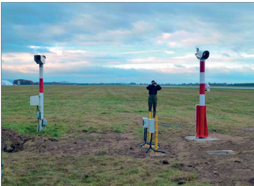
Starý (MITRAS single base, vlevo) a nový (LT31, vpravo) typ transmisometru vedle sebe na letišti v Brně-Tuřanech, pozice MID RWY28. Foto: Petr Černý.
