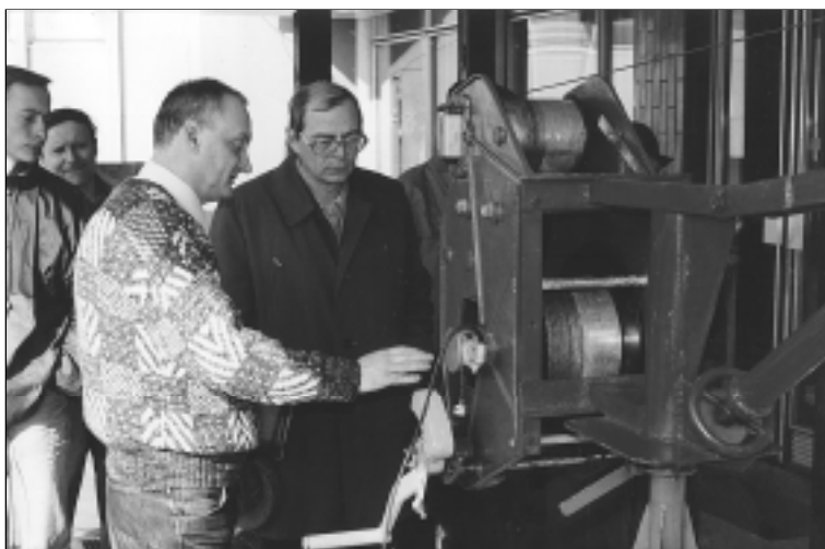
Obr. 2 Ukázka hydrometrické soustavy pro měření velkých vod z mostu. Foto J. Jandouš.
