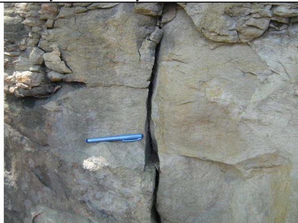
Foto 271: Detail rozevřené pukliny
