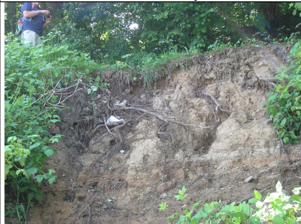
Foto 233: Dílčí odlučná stěna pod starou cestou.
