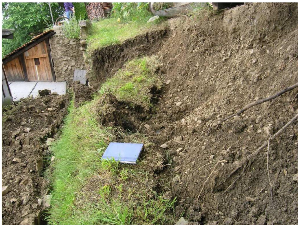
Foto 262: Odlučná stěna a hmota sesuté terasy
