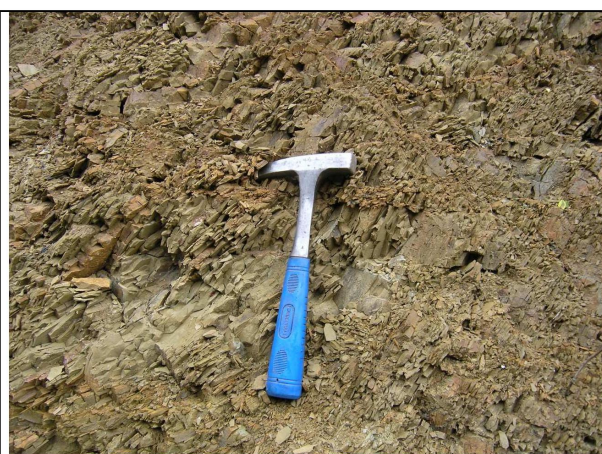
Foto 243: Detailní pohled na horninu ve svahu - střípkovitě rozpadavé břidlice kosovského souvrství.
