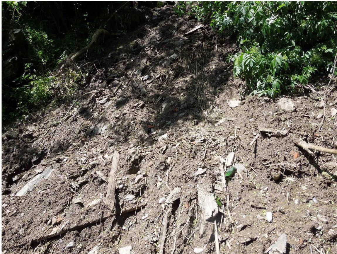
Foto 225: Detailní pohled na směsný materiál sesuvu s převládající zeminou
