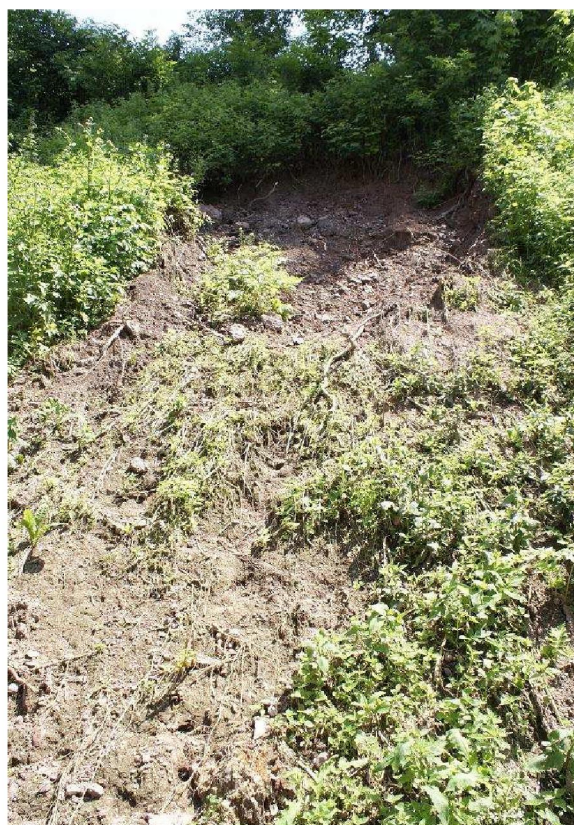
Foto 101: Odlučný a transportní prostor levé a pravé části sesuvu při pohledu zdola
