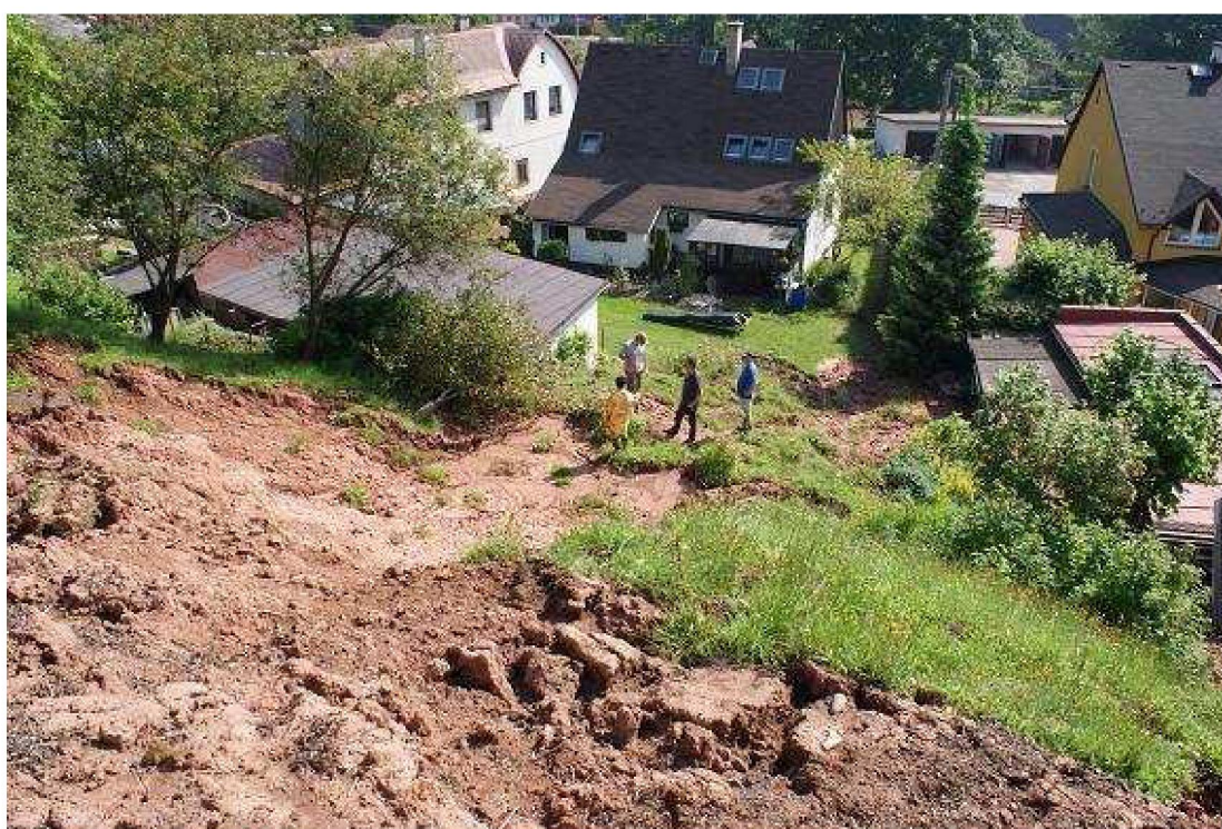
Foto 50: Transportní a akumulční oblast pravé části sesuvu
