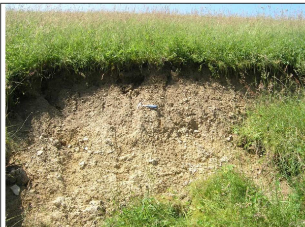
Foto 54: Sesuv A – obnažený svah – deluviální hlíny a spraše.
