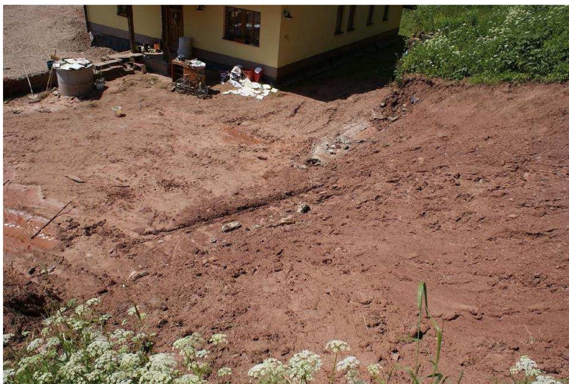
Foto 79: Transportní a akumulční oblast sesuvu (materiál z akumulční oblasti odstraněn)
