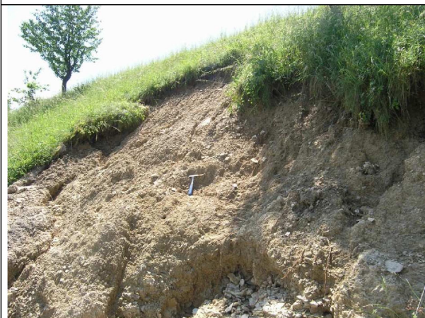
Foto 58: Sesuv C – vpravo dole obnažené polohy prachovců.
