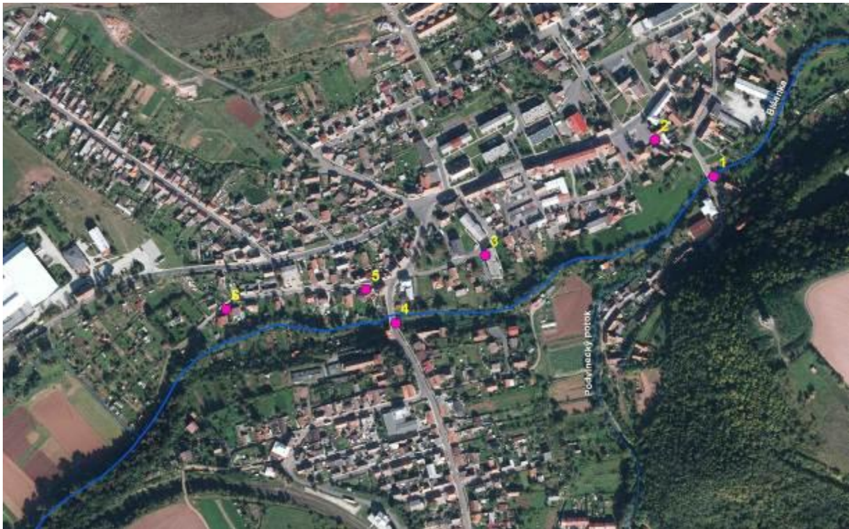
Obr. 4.3 – Povodňové značky na Blšance v Kryrech zaměřené po povodni v červnu 2013, Ortofoto © ČÚZK
