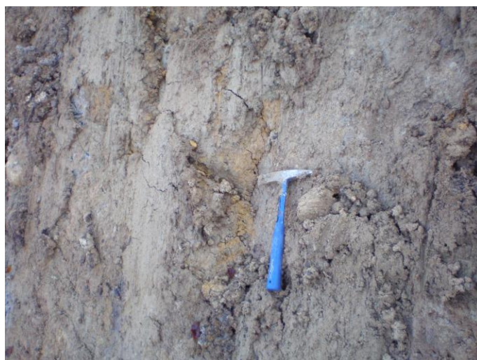
Foto 4 Část smykové plochy s lineárními znaky pohybu.
