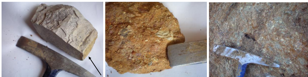
Foto 7 Příklady podložních hornin: 1) vápnitý jílovec jizerského souvrství, šipka ukazuje na zvětralou plochu pukliny; 2) zdravá tefra; 3) rozložená tefra.
