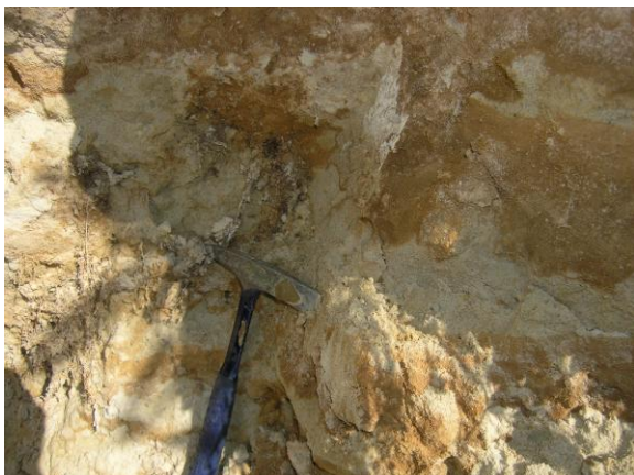
Foto 4 – Detailní pohled na složení svahu – zvětralé a rozložené pískovce. (foto J. Krupička)
