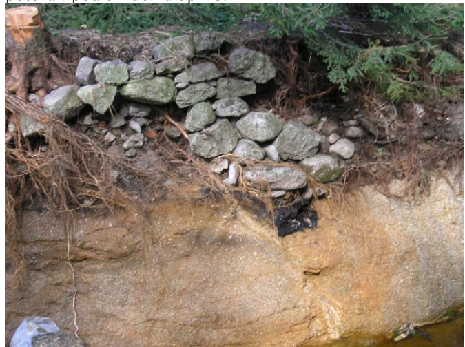
Foto 4 – Pohled na vrstvy deluviofluviálních sedimentů a podložní žulu
