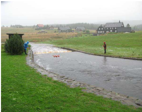
Obr. 3.16 Měření průtoku u limnigrafu na Jizerce
