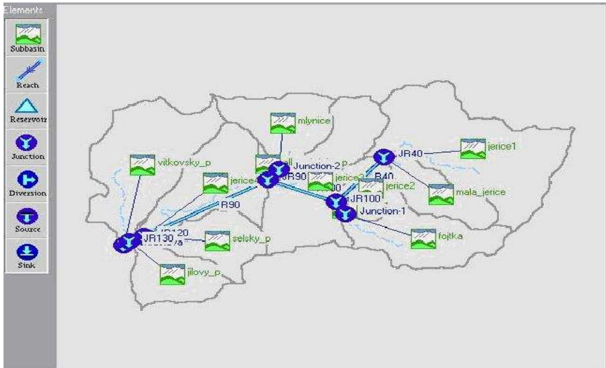
Obr. 4.1 Schéma modelu povodí Jeřice v programu HEC-HMS
