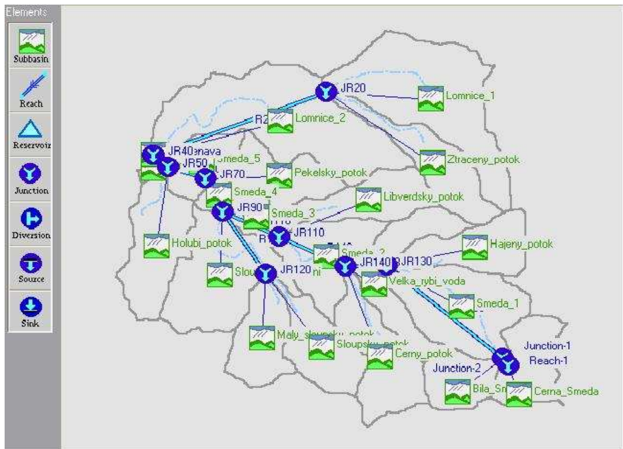
Obr. 6.1 Schéma modelu povodí Smědé v programu HEC-HMS
