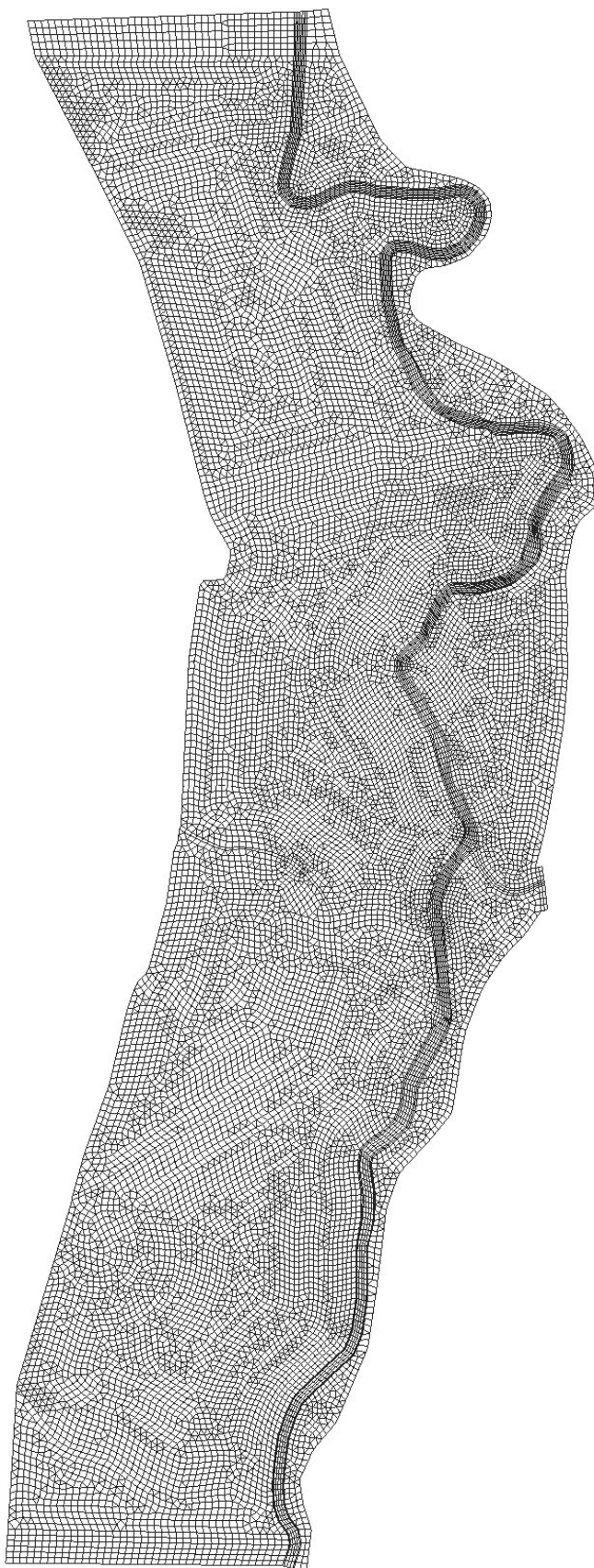
Obr. 11.2 Schematické znázornění výpočetní sítě 2D modelu záplavového území na Smědě v úseku mezi obcemi Višňová a Předlánce
