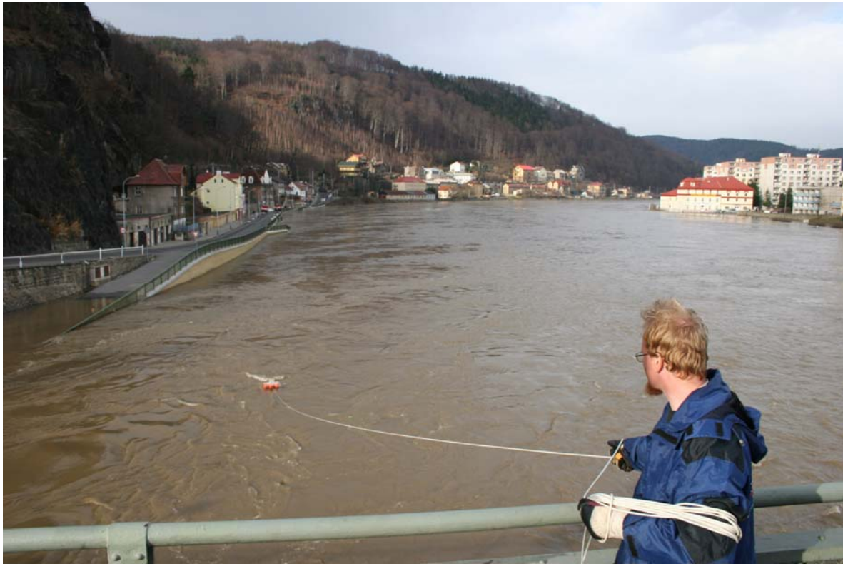
Obr. 3.1 Měření průtoku systémem ADCP (na Labi v Děčíně)
