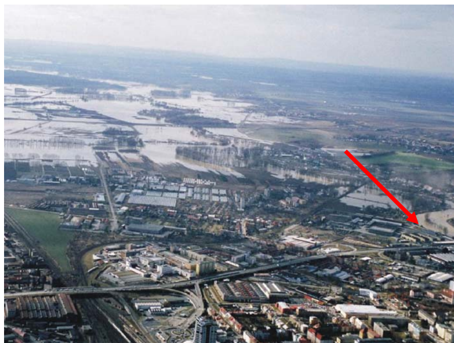
Obr. 82 Olomouc-jih, Nové Sady, limnigraf, neděle 2. dubna 2006. Kulminace byla dosažena při stavu 533 cm 2. dubna a průtoku odpovídajícímu úrovni Q_{20} (o více než 1m méně v roce 1997 – 647 cm). Foto: Raudenský, M.
