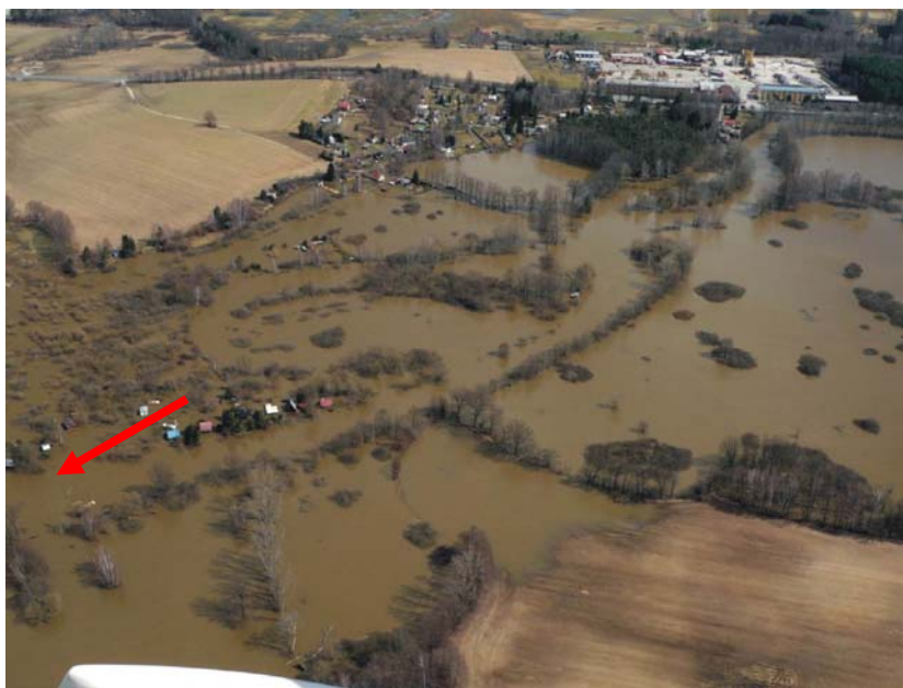
Obr. 42 Lužnice, Klenovice, 30. března 2006. Hladina dosáhla úrovně Q_{50} , srovnání s výškou z roku 2002 umožňuje povodňová značka (šipka). Foto: Hovorka, P. Rozlivy (vpravo) mezi Soběslaví a Klánovicemi (umístění stanice je mimo snímek, směr ukazuje šipka). Foto: Raudenský, M.
