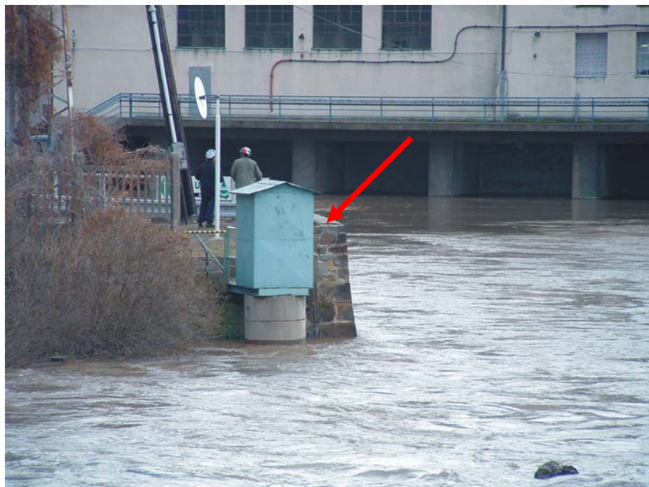
Obr. 29 Brandýs nad Labem – Labe. Detail stanice za povodně. Stanice byla i za nejvyšších stavů dobře přístupná. Kulminace byla dosažena při stavu 525 cm, Foto: Elleder, L.
