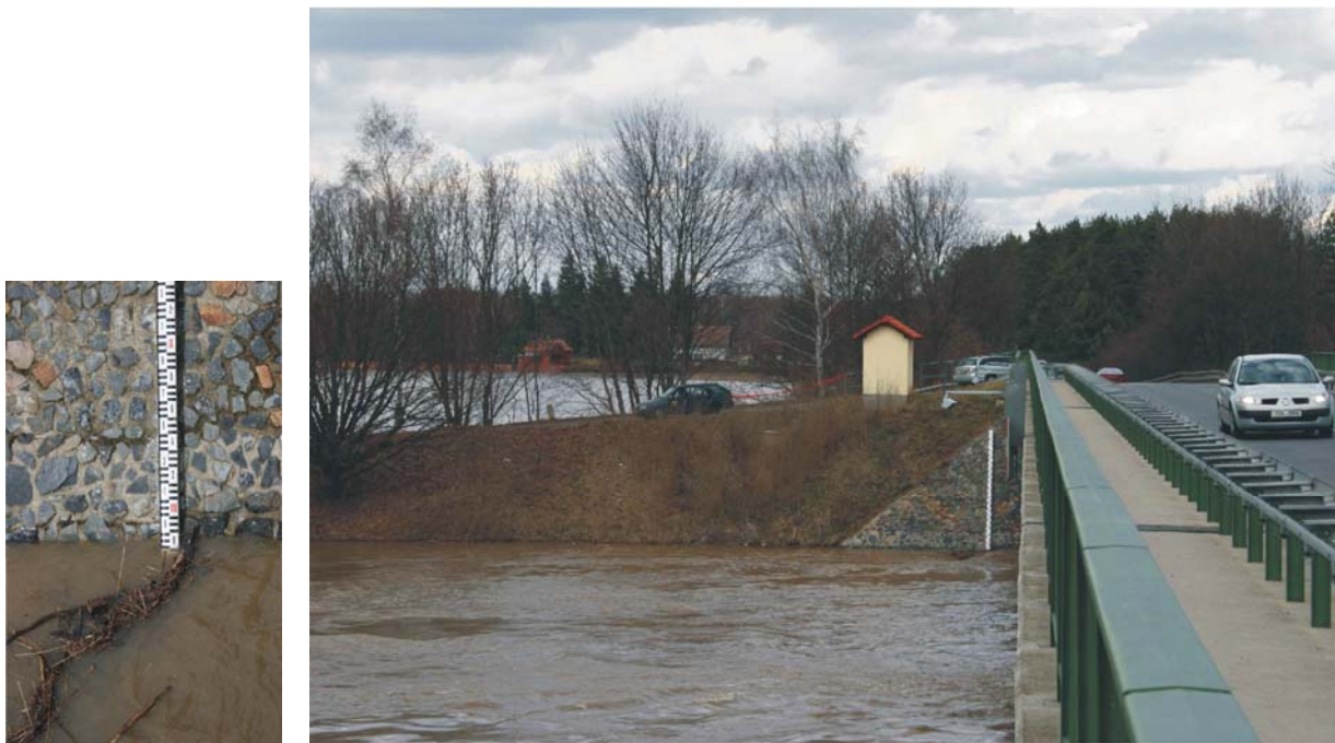
Obr. 34 Kostelec nad Labem, profil limnigrafu 1. dubna 2006. Fotografie pořízená v rámci měření průtoku (byl změřen průtok cca 1000 \text{ m}^3 \cdot \text{s}^{-1} ). Foto: Kurka, D.
