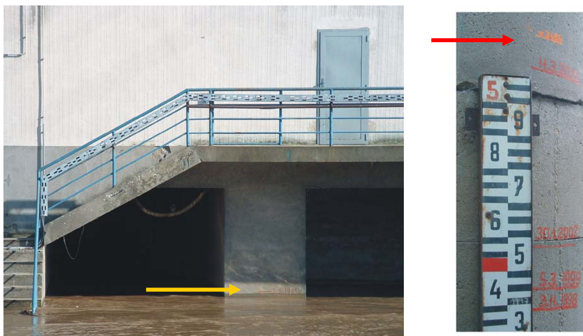
Obr. 33 Brandýs nad Labem. Značka (šipka) na odtoku z elektrárny poukazuje na dosažení úrovně od té doby nepřekonané záříjové povodně 1938 (žlutá šipka). Vpravo vodočet na stanici s vyznačenými povodňovými značkami z poslední doby v porovnání s úrovní hladiny v dubnu (červená šipka), Foto: Elleder, L.
