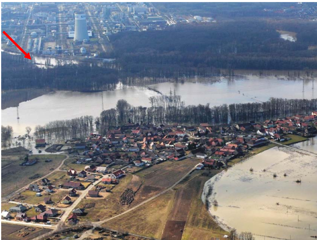
Obr. 36 Spolana Neratovice a obec Tuháň, poslední úsek Labe nad soutokem s Vltavou. Pravostranné rozlivy Labe u obce Tuháň (viz též kapitola 4.7) zvyrazňují fakt, že historická sídla i v Polabí byla tentokrát postižena většinou minimálně. Fotografie zároveň ilustruje obecnější zkušenost, že obce v Polabí historicky vznikaly na místech chráněných před cca 10–20letými průtoky, až na nemnohé výjimky. Podobný pohled jako na této fotografii by se naskytl i na další obce v okolí. Patří k nim Křenek, Borek, Kozly, Tišice a některé další. Výjimku tvoří Křešice u Litoměřic, ležící kolem zaústění potoka, jejichž jádro stálo při povodni na jaře 2006 opět pod vodou. Foto: Raudenský, M.
