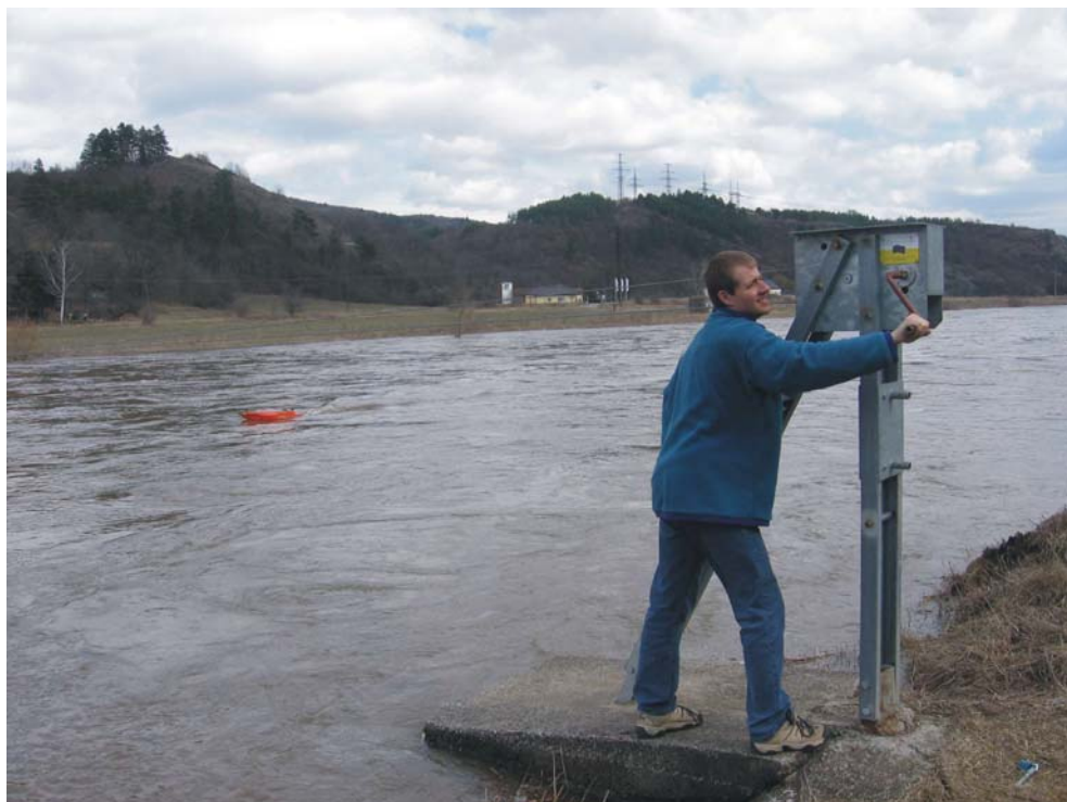
Obr. 62 Berounka, Beroun, pátek 31. března 2006. Měření průtoku s ADCP za pomoci lanovky. Situace v povodí Berounky byla naštěstí i pro Prahu mnohem méně významná. Foto: Kurka, D.
