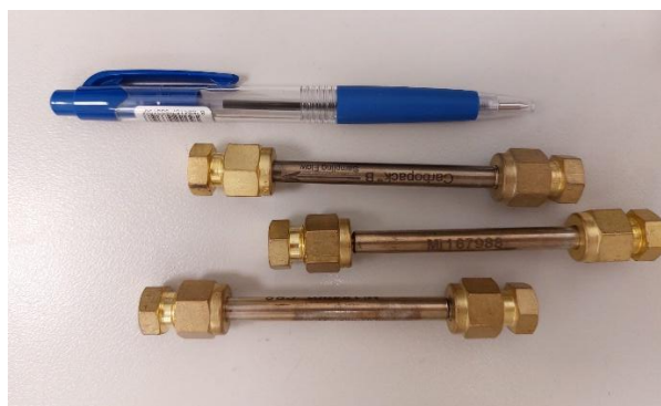
Obr. 14. Pasivní vzorkovací trubice PDBE (typ carbopack B) pro měření benzenu v ovzduší. Zdroj: ČHMÚ, Centrální laboratoř imisí
