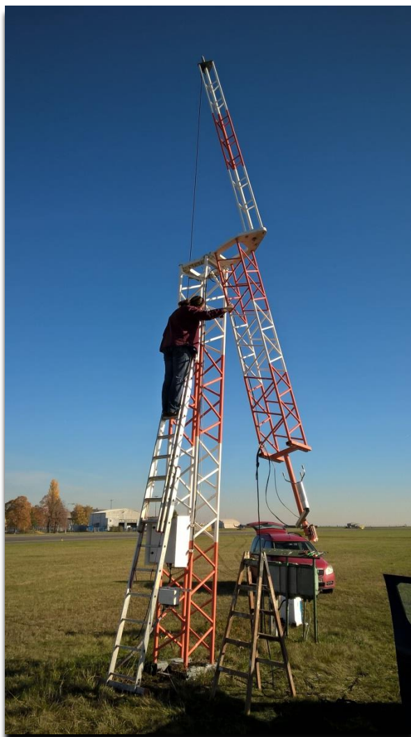
Výměna ultrasonického anemometru WS425 za typ WMT702 v pozici MID RWY30 na letišti Praha/Ruzyně (foto: Ing. Petr Černý)
