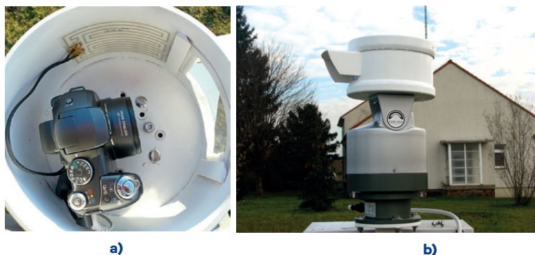
Obr. 4 Fenologická kamera – vyhřívaná nádoba s průzorem (a) a otočný a naklápěcí stojan (b).
