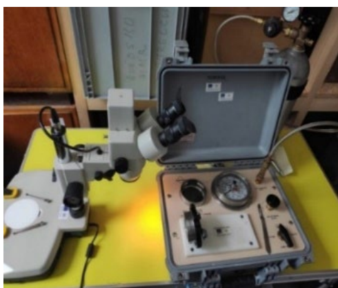
Obr. 2 Scholanderova tlaková komora s binokulárnou lupou (vľavo) a pozorovanie ihlice zatvorenej v komore (vpravo).
