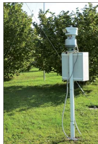
Obr. 4 Digitální kamera pro monitoring fenologických fází v Doksanech.
