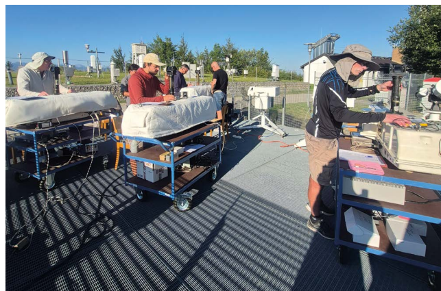
Kalibrace Dobsonova spektrofotometru D074 v Regionálním kalibračním centru WMO pro Evropu v Hohenpeißenbergu v Německu. Foto: archiv Solární a ozonové observatoře ČHMÚ.
