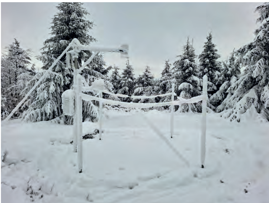
Obr. 2 Automatická sněhoměrná stanice ASNS (samostatně stojící, ultrazvuk), Velká Deštná, leden 2026. Foto: Veronika Vosáhlová.
