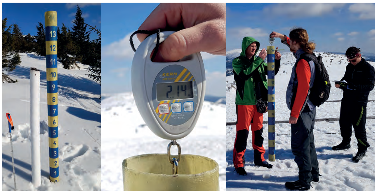
Obr. 1 Sněhová sonda, sněhoměrný válec, vážení odebraného vzorku sněhu ve válci na hřebenech Krkonoš.
