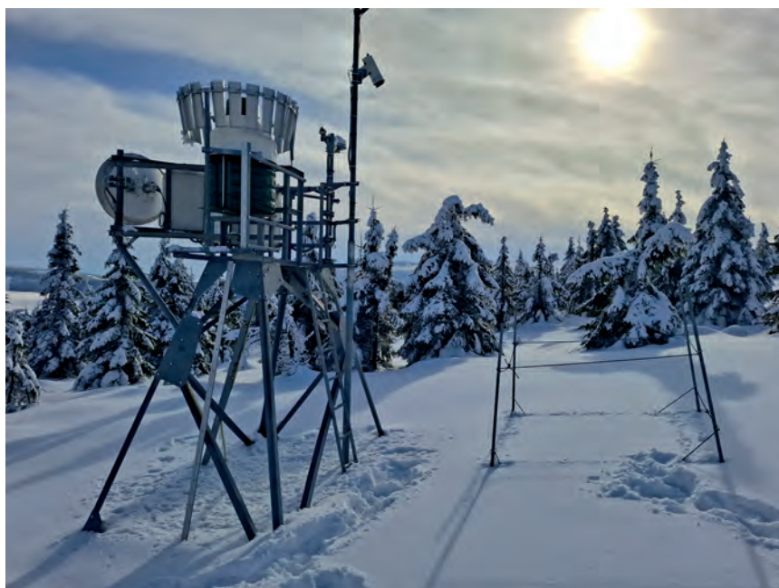
Obr. 1 Automatická sněhoměrná stanice ASNS (laser paprsek), Labská bouda, únor 2026. Foto: Veronika Vosáhlová.
