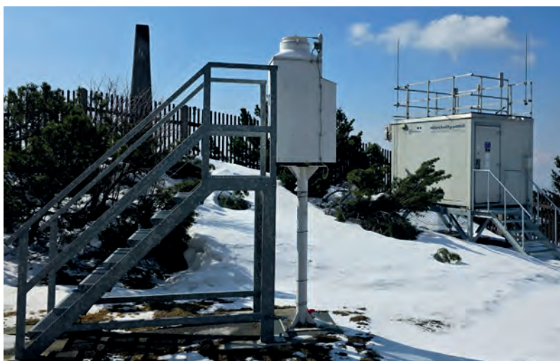
Obr. 5 Automatická monitorovací stanice kvality ovzduší a pluviokolektor z března roku 2026 na Lysé hoře, foto: Vladimíra Volná, ČHMÚ.
