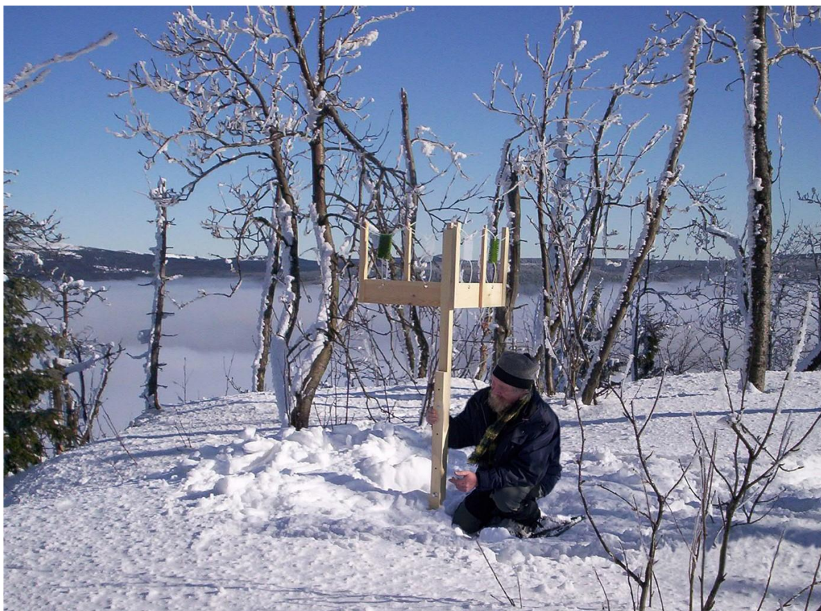
Obr. 22 Instalace odběrového zařízení v horském terénu
