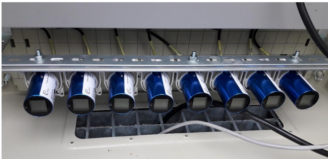
Obr. č. 1. Autonomní měřicí jednotky Cairclip od firmy Cairpol (Environment SA, Envea, FR). Foto: P. Bauerová
