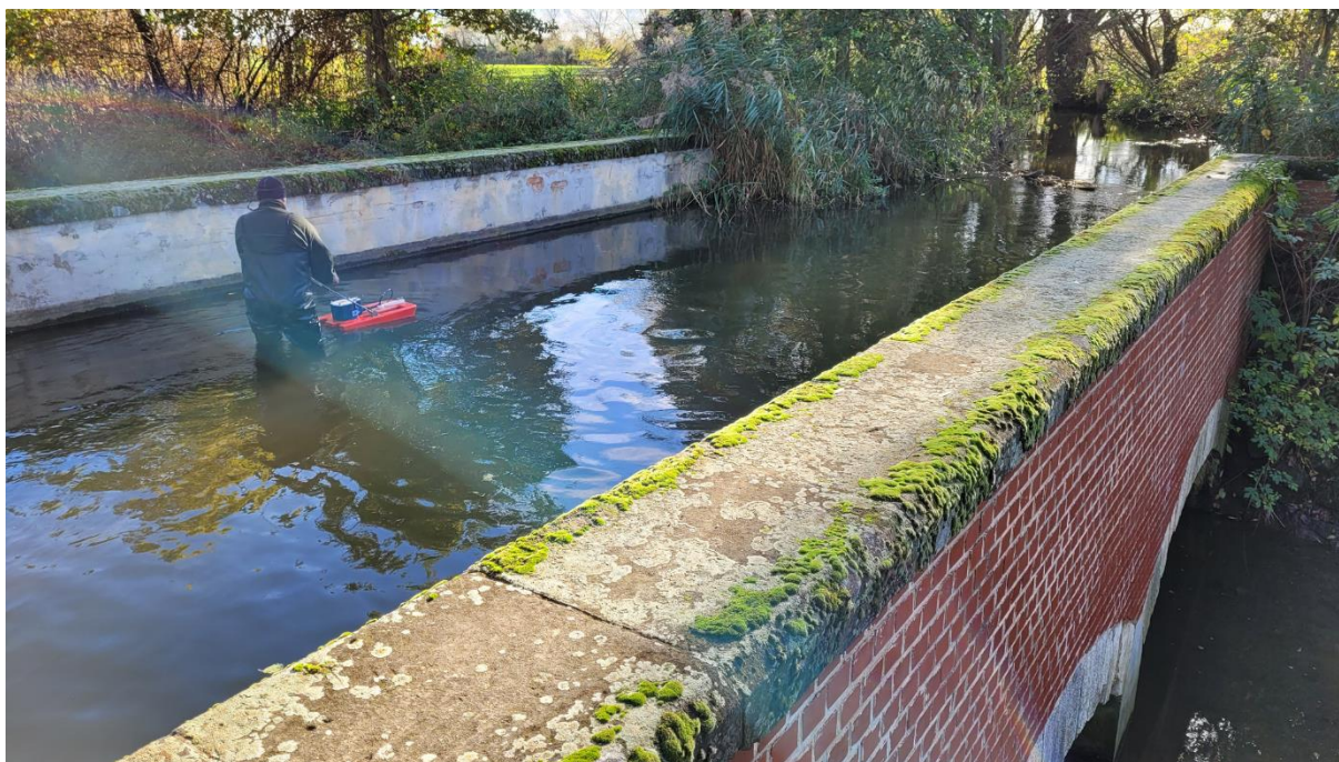
Obr. 21 Měření průtoků ADCP přístrojem na Malém Sezemickém akvaduktu (foto Jan Unucka)
