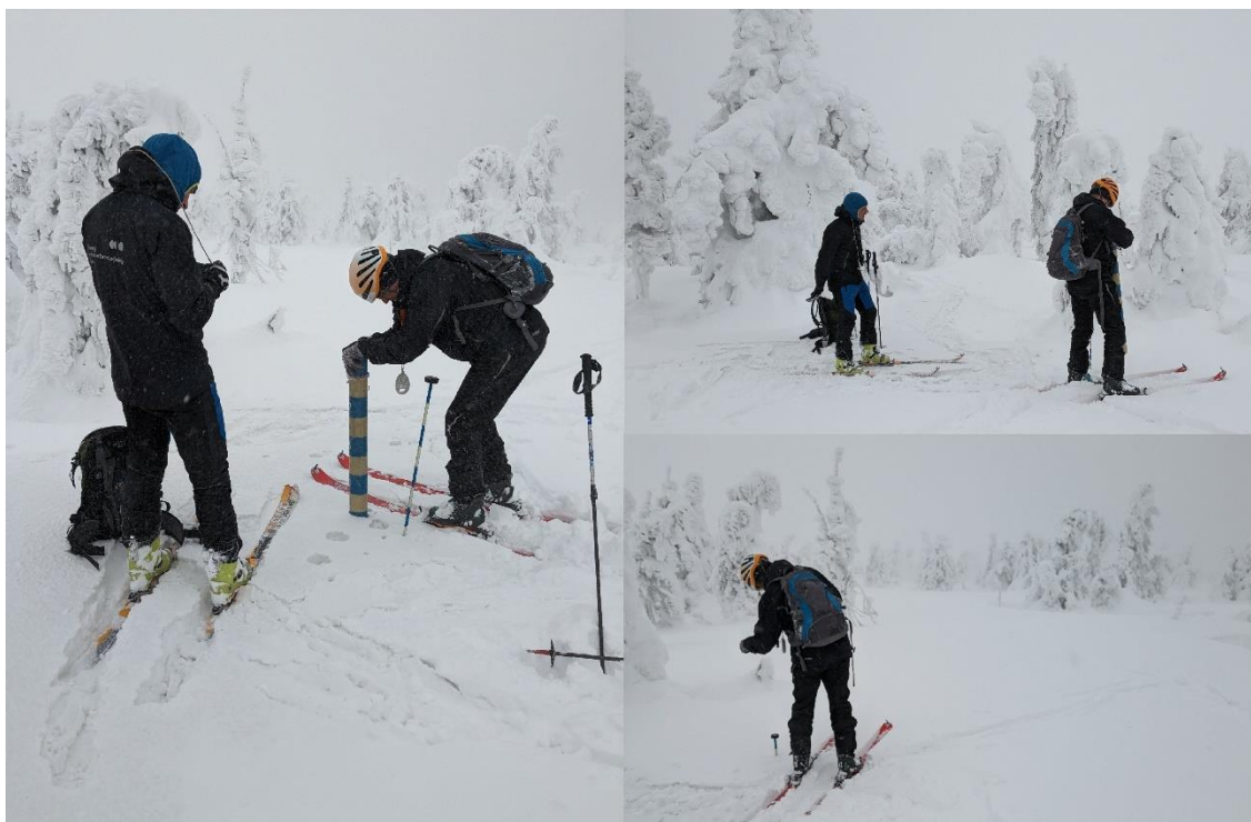
Obr. 20 Měření výšky a vodní hodnoty (79 cm/190 mm) na lokalitě Malý Děd, Švýčárna dne 1. února 2023
